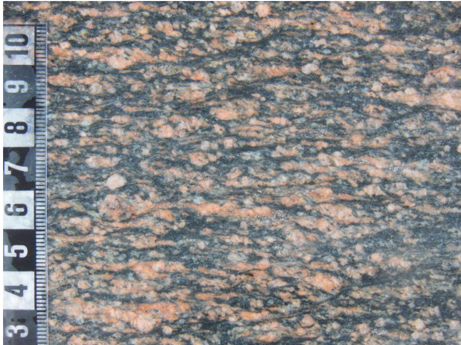
Figur 1: Ojämnkornig, finkornig till fint medelkornig, rödgrå ortognejs från den aktuella tåkten. Bergarten är ställvis kraftigt deformerad och mörka stråk av biotit (glimmer) är vanligt förekommande i bergarten. Vid nedkrossning av en sådan bergart kan man i dagsläget inte utesluta att glimmermineralen anrikas i finfraktionen och försämrar de reologiska egenskaperna (pumpbarhet och arbetbarhet) för en betongblandning.
