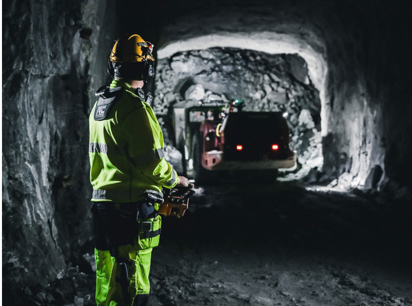
Automatiserad lastning och transport i Garpenberg. Foto: Tomas Westermark/ Boliden.
