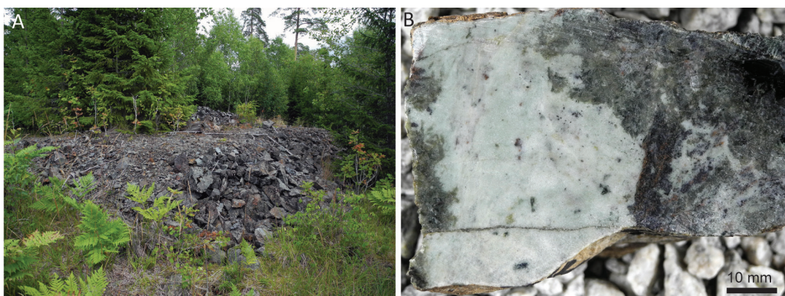
Figur 32. A. En relativt stor varp finns vid Runviksgruvan 1 nordöst om Rönnviken. Gruvhålet är dock igenfyllt efter att en älg gått ner sig i hålet. Varpen består av kalkigt grönskarn vari magnetit förekommer ganska rikligt. Det finns även en del disseminerad pyrit och magnetkis, vilket ger rostig varp. B. Ett block från varpen med karbonatrikt skarn där zinkblände noterades visade sig vid analys vara rikt på zink (9,3 %) med något bly (0,95 %) och med anomala halter för en rad spårelement, bl.a. indium (62,4 ppm), silver (411 ppm) och guld (0,13 ppm). Foto: Fredrik Hellström.
