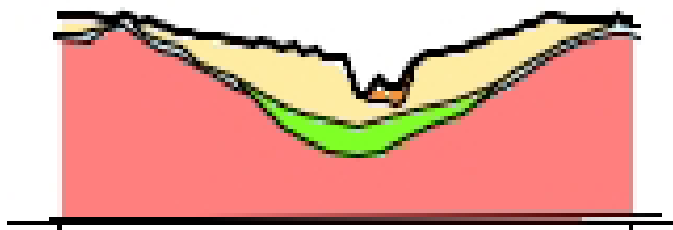
Figur 10A. Sektioner tvärs Jumkilsåns dalgång där inget isälvsmaterial finns i markytan men har en betydande utbredning djupare ner i marken. Kartan visar sektionens läge från söder till norr.
