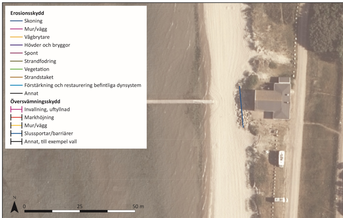
Figur 15. Ett exempel på en skoning av sten och block söder om Helsingborg som orsakar större erosion och borttransport av sand vid sidorna av erosionsskyddet. Markeringen av skoningen, blå linje, samt teckenförklaring med symboler är tagna från den framtagna geodatabasen av befintliga erosions- och översvämningsskydd.
