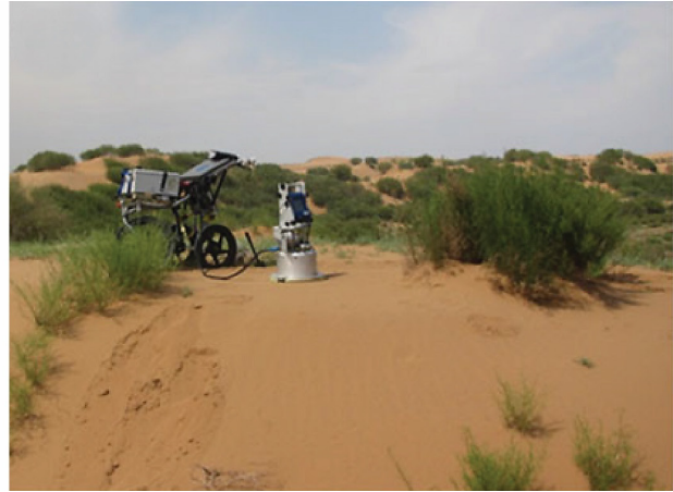
Figur 9. Schematisk bild och foto av PI-SWERL. Instrumentet genererar virvlar och mäter utsläppsmängder och partikelstorlekar. Källa: Etyemezian m.fl. (2007) och Cui m.fl. (2019).
