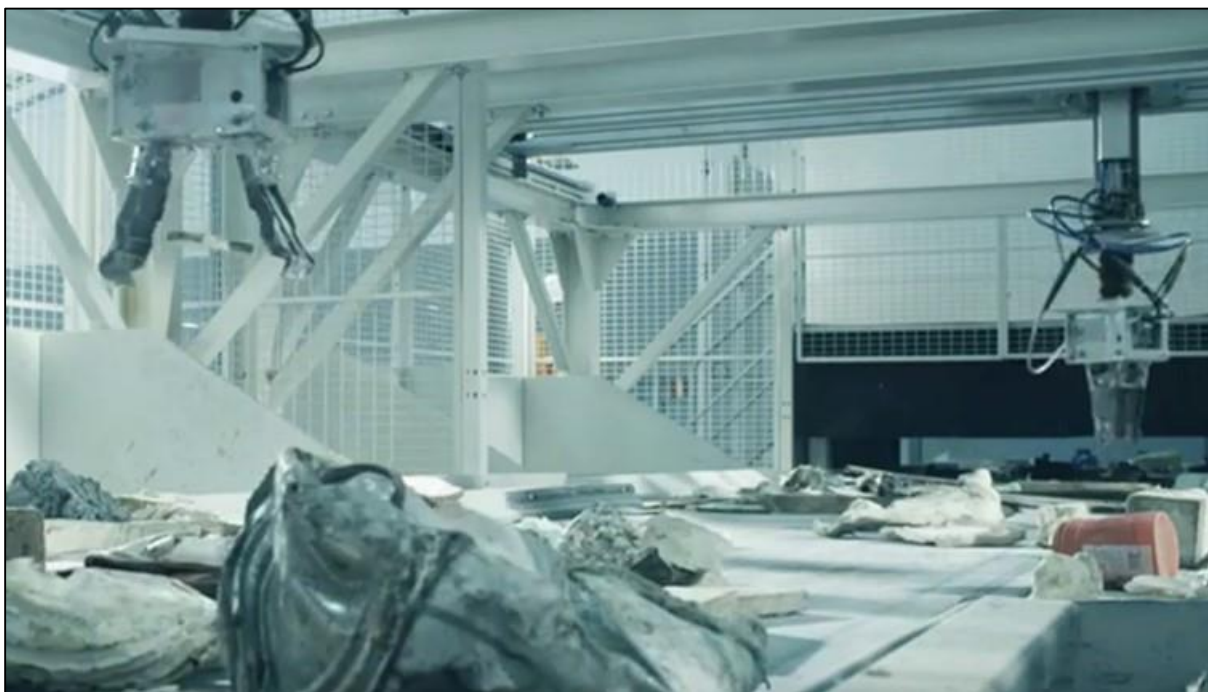
Figur 5. Separation av avfall baserat på plockarmsteknik. Bilden är hämtad från företaget ZenRobotics.
