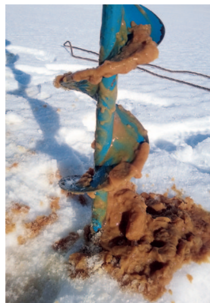
Ett borrprov från den överfulla sedimentationsbassängen.
