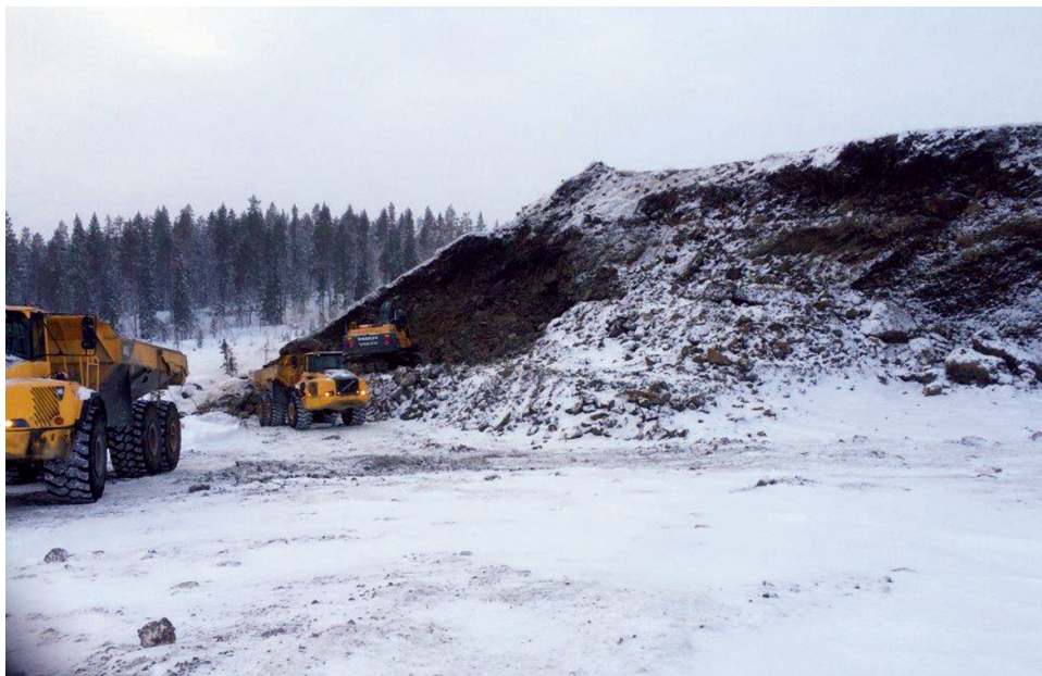
Gråberg från tippen lastas för att återfyllas i det norra dagbrottet.
