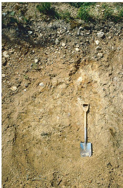
Fig. 14. Skärning i två lager av lerig moig morän samt vid markytan ett obetydligt lager av svallad sandigmoig morän. 1 km sydväst om Lilldalen (7j), norr om landsvägen. Foto förf. 1991.
