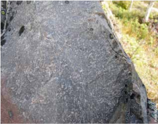
Exempel på en bergart med mycket bra tekniska egenskaper för vägbyggen. Det är en grå, mycket finkornig till tät, porfyrisk metakanit som till exempel används för högtrafikerade motorvägar.
