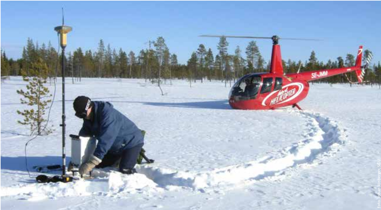
Mätning av tyngdkraften på en myr i Norrbotten.
