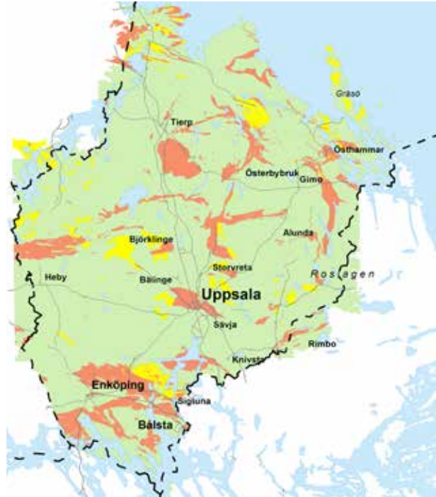
Tematisk karta som visar förutsättningarna för att producera ballast för betong. Grön färg visar områden där bergkvaliteten lämpar sig för de flesta användningsområden för betong. Gul färg visar bergkvalitet där vissa användningsområden för betong kan vara svåra att uppnå och röd färg visar bergkvalitet där användningsområdena för betong är starkt begränsade.
