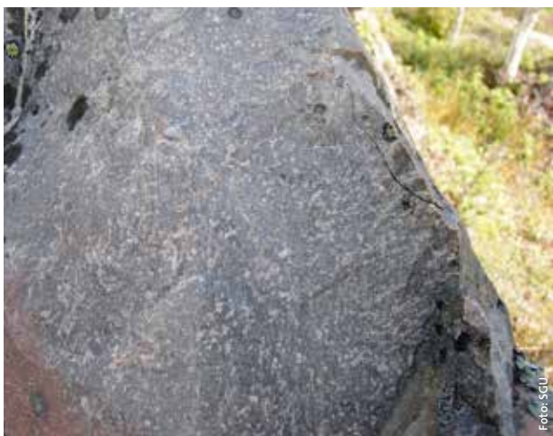
Exempel på en bergart med mycket bra tekniska egenskaper för vägbyggen. Det är en grå, mycket finkornig till tät, porfyrisk metavulkanit som till exempel används för högtrafikerade motorvägar.
