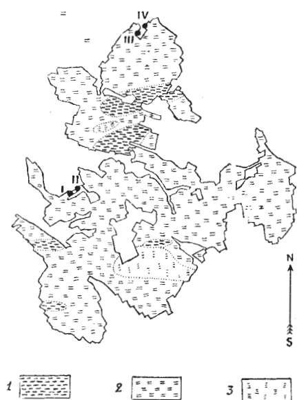
Fig. 181. Kartskiss angifvande de ungefärliga områden i Bjufs grufva inom hvilka öfre flötsens stenkol äro fördelade på ett, två eller tre lager. Skala 1:25,000.
