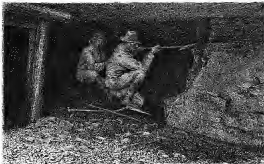
Fig. 195. Arbetsrum i Bjufs kolgrufva, öfre flötsen. Pennteckning af P. RÖDING efter foto erhållen vid Bjuf 1896. — De båda männen »förskrämma».
