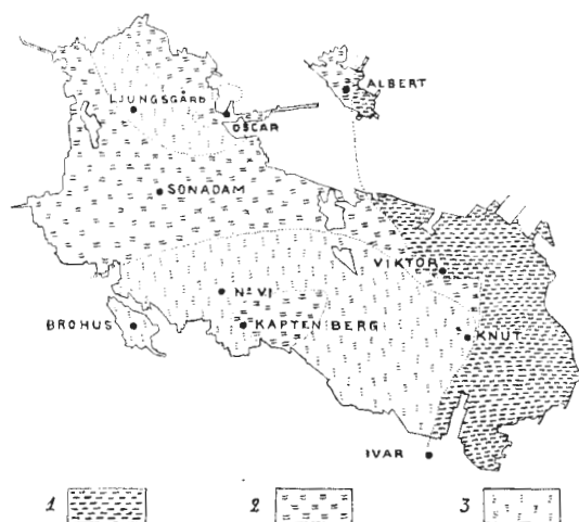
Fig. 162. Kartskiss angivande de ungefärliga områdena i Billesholms grufva, inom hvilka öfre flötsens stenkol äro fördelade på ett, två eller tre lager. Skala 1:50,000.
