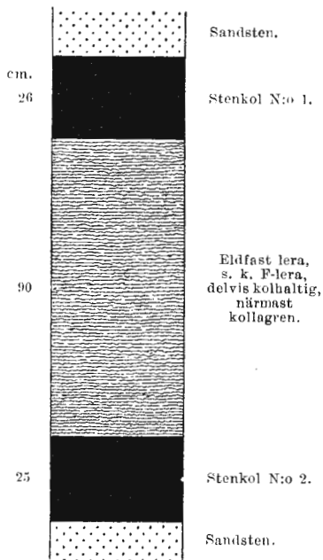
Fig. 175—180. Vertikalsektioner genom öfre kolflötsen (flöts A) inom brytningsområdet för schaktet III samt östra delen af brytningsområdet för schakten I och II vid Bjuf. Skala \frac{1}{20} .
