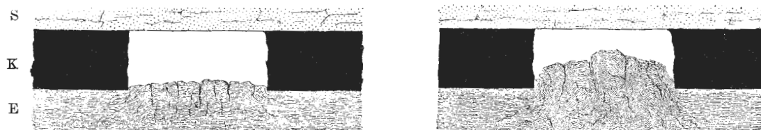
Fig. 106 och 107. Tvärgenomskärningar af en ort med från botten efter hand inpressad lera. (Höganäs, gamla grufvan. Utan skala.)
