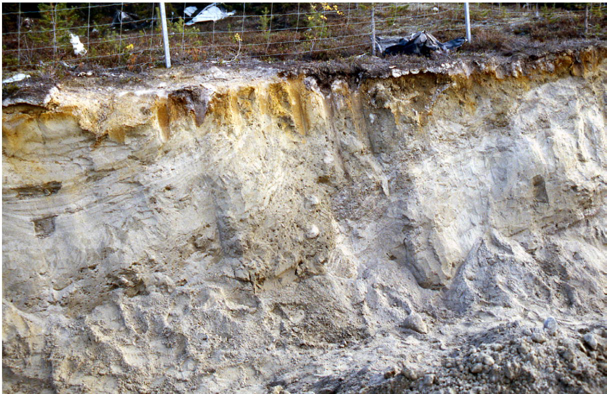
Fig. 3. Vid Malås sopstation (6 h) finns omväxlande lager av morän och sorterade vattenavsatta sediment (sand och silt) inom ett flackt och blockfattigt område. Sedimenten är vanligtvis deformerade. På 8 m djup under markytan påträffades grovt grus, sten och block. Foto: G. Ransed.
