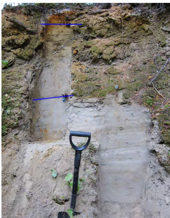
Fig. 48. Ett schakt i norra delen av Spångsjömon, lokal F2. Överst syns flygsand, därunder grovsilt till finsand som överlagrar glacial finsand. Foto: Gustaf Peterson.
