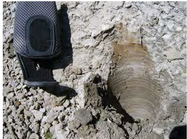
Figur 18. I en ravin norr om Barsbacken (lokal A6) observerades tydligt varvig lerig silt några meter under omgivande markyta. Foto: Mikael Berglund.
