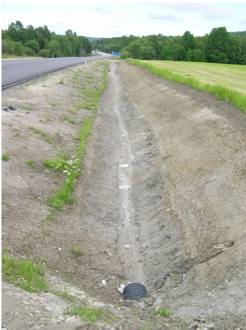
Figur 8. Den ljusbrunt rostflammiga delen av lagerföljden är oxiderad. Den tydliga färggränsen nedåt i diket är en s.k. oxidationsfront, under den är leran inte oxiderad och uppvisar en blågrå färg, delvis tack vare sulfidinnehållet. Foto: Johan Norrlin.
