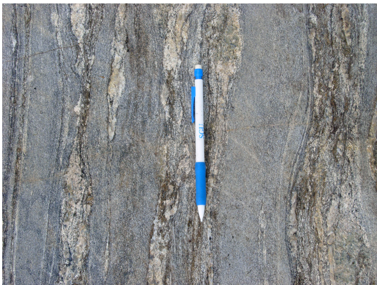
Figur 3. Grå, finkornig, ådrad ytbergartsgnejs, Myggstaviken (MGO090022A, 6426035/314416) med mycket goda tekniska egenskaper, A_N -värde = 8 % och LA-värde = 16 %. Pennan på bilden är 15 cm lång. Foto: Mattias Göransson.
