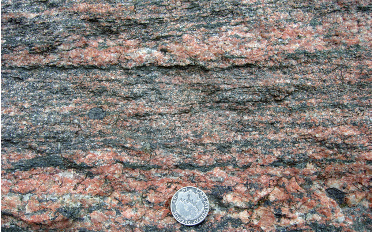
Figur 5. Rödgrå, finkornig till medelkornig, ådrad, gnejsig granodiorit 800 m sydväst om Tjurholmen (MGO090038A, 6428617/308446) med mycket bra tekniska egenskaper, A_N -värde = 9 % och LA-värde = 17 %. Myntet är ca 25 mm stort. Foto: Mattias Göransson.
