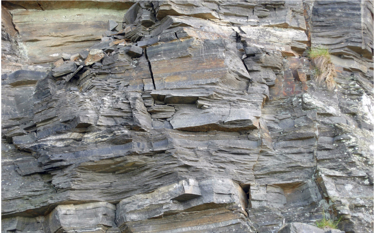
Figur 4. Grå, finkornig till medelkornig, ådrad ytbergartsgnejs, skifferbrott vid Tjuvkils huvud (MGO090032A, 6422416/305368). Gnejsen är relativt kraftigt förskiffrad med moderat till brant lutande sprickplan vilket ger bergarten en välutvecklad klyvbarhet. Berget har dåliga tekniska egenskaper, A_N -värde = 26 % och LA-värde = 23 %. Vyn är ca 2 x 2,5 m. Foto: Mattias Göransson.
