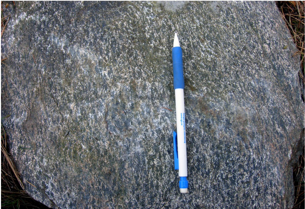
Figur 8. Svart, medelkornig gabbro (MGO090006A, 6420821/322152) med moderata tekniska egenskaper, A_N -värde = 16 % och LA-värde = 20 %. Foto: Mattias Göransson.
