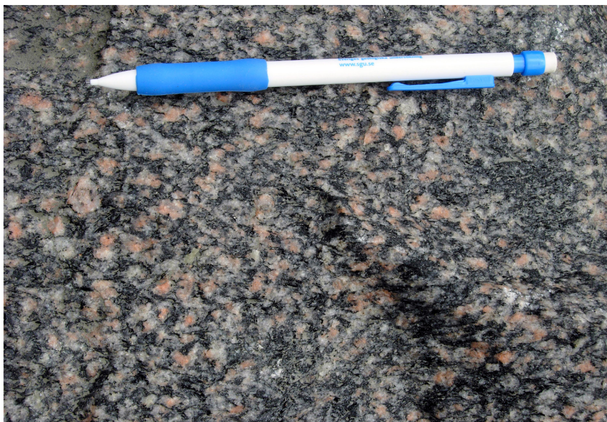
Figur 7. Porfyrisk, rödgrå, medelkornig, stänglig och gnejsig, glimmerrik granodiorit från Skälebräcke bergtäkt (MGO090004A, 6431258/326588) med moderata tekniska egenskaper, A_N -värde = 16 % och LA-värde = 28 %. Foto: Mattias Göransson.
