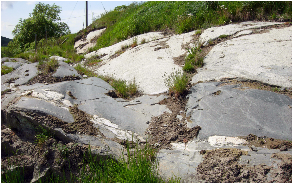
Figur 6. Kontakt mellan grå, stänglig tonalit och amfibolit vid Dotorp (MGO090026A, 6431599/329184). Teknisk analys är gjord på tonaliten. Bergarten har bra tekniska egenskaper, A_N -värde = 13 % och LA-värde = 21 %. Foto: Mattias Göransson.
