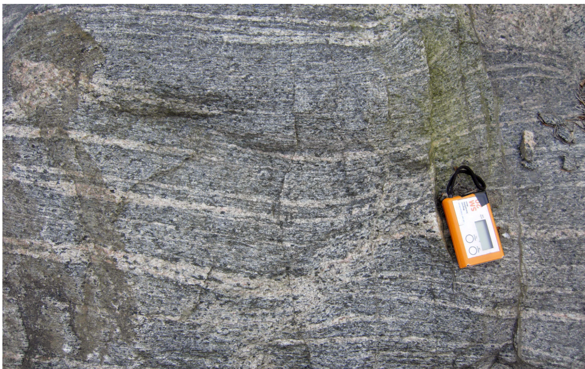
Figur 3. Grå, grovt medelkornig, ådrad ortognejs (MGO100027A, 6396602/ 322451) från Kallebäck, 1 km norr om projektområdet. Berget har medelbra motståndskraft mot skavande nötning, A_N -värde = 13 %. Vyn är ca 65 × 90 cm. Foto: Mattias Göransson.
