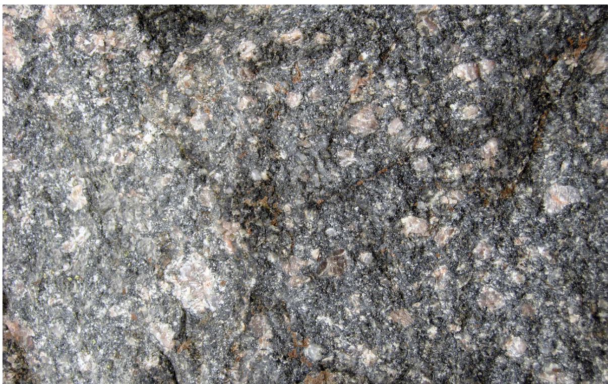
Figur 4. Mörkfärgad grå, finkornig, porfyrisk, gnejsig granodiorit (MGO090017A, 6366577/ 317178) med medelbra tekniska egenskaper, A_N -värde = 14 % och LA-värde = 20 %. Vyn är ca 18 × 25 cm. Foto: Mattias Göransson.
