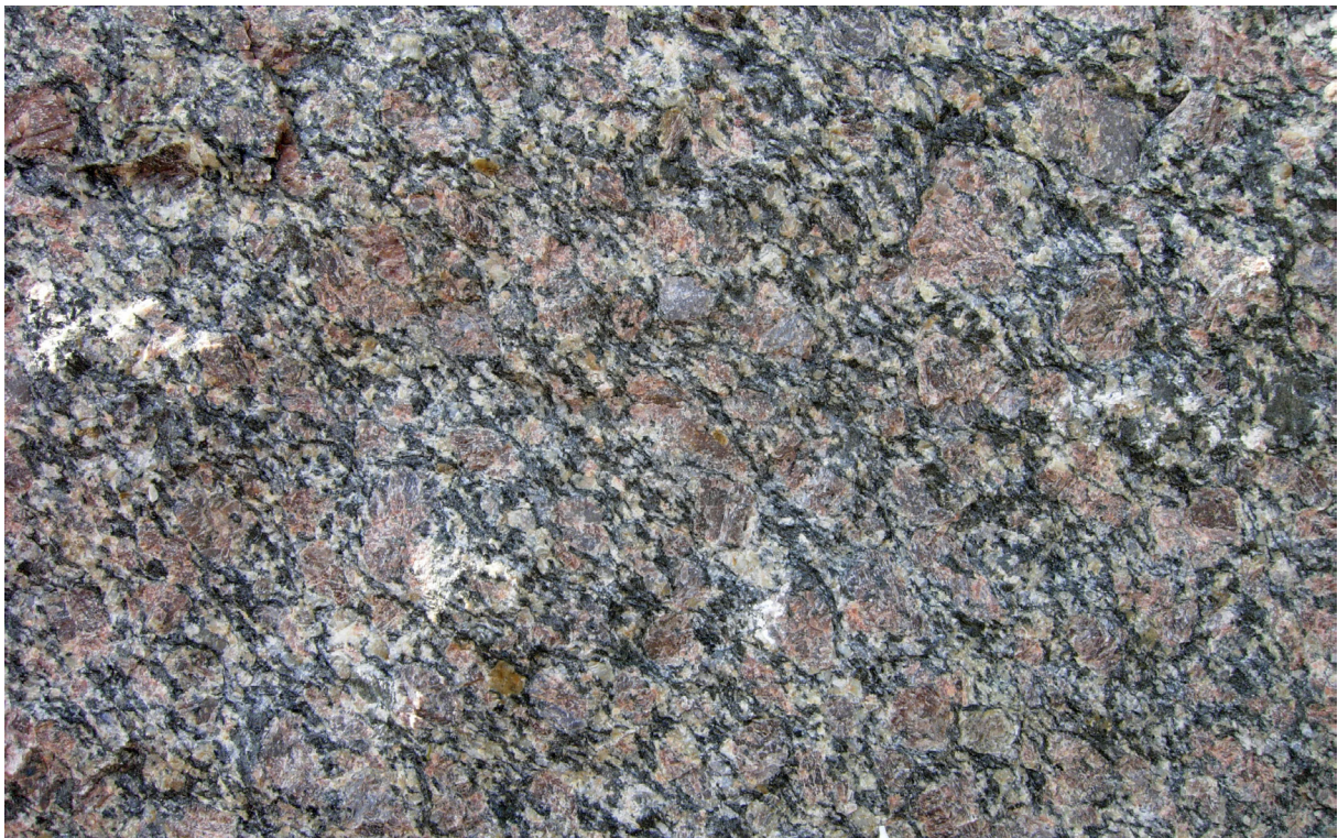
Figur 5. Rödgrå till gråröd, medel- till grovkornig, grovporfyrisk, gnejsig Askimsgranit (MGO090014A, 6364557/320696) från samhället Gottskär. Berget har medelbra tekniska egenskaper, A_N -värde = 13 % och LA-värde = 21 %. Vyn är ca 20 x 26 cm. Foto: Mattias Göransson.
