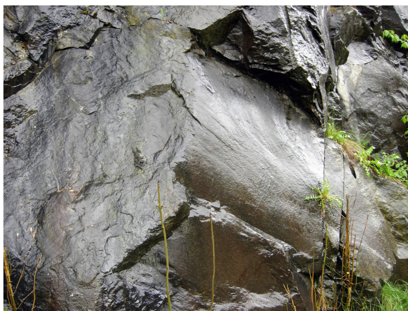
Figur 10. Svart, finkornig, mafisk bergart med mussligt brott ca 2,0 km sydväst om Buerås (MGO090010A, 6375464/322087) med dåliga tekniska egenskaper, A_N -värde = 22 % och LA-värde = 14 %. Vyn är ca 75×100 cm. Foto: Mattias Göransson.
