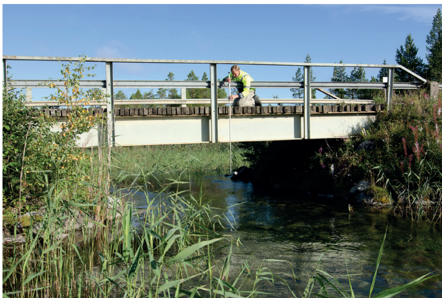
Figur 8. Flödesmätning vid Locknesjöns utlopp. Foto: Magdalena Thorsbrink.
