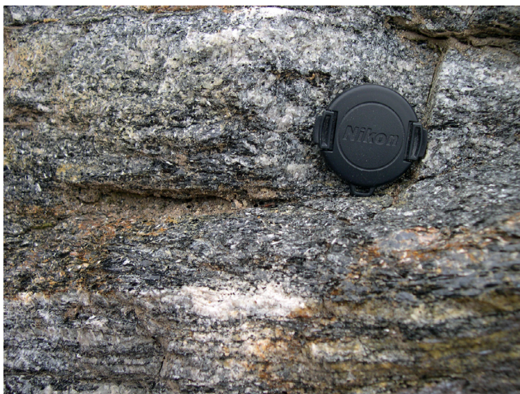
Fig. 7. Glimmerrik, ådergnejsomvandlad granodiorit till tonalit belägen i den östra flanken av Mylonitzonen (vid E20, ca 2 km nordöst om Tollered). Den grova glimmern bildar kontinuerliga ”band” (svaghetsplan) i bergarten vilket lokalt ger extremt dåliga bergmekaniska egenskaper och problematiserar förutsättningarna för byggnation. Foto Mattias Göransson.
