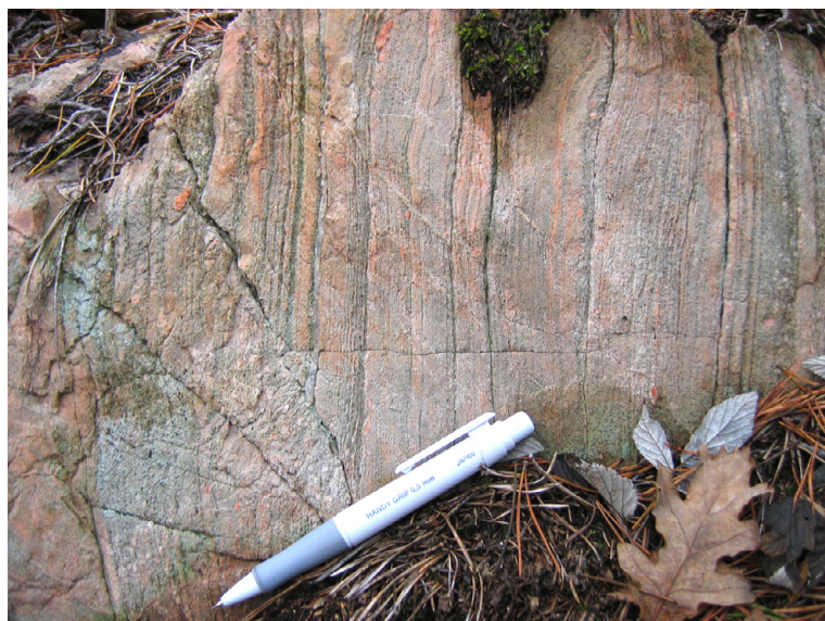
Fig. 8. Dynamiskt omkristalliserad granit i Mylonitzonen (FRJ041308, 6455245/1316313). De starkast deformerade bergarterna, i synnerhet med en granitisk sammansättning, bör rimligen duga som klass 1-material visar arbetet från intilliggande kommuner (Bergström m.fl. opublicerat). Bergmaterialet bör dock inte användas utan vidare för betongändamål då myloniter normalt bedöms vara mycket alkalisilikareaktiva. Foto Fredrik Hellström.
