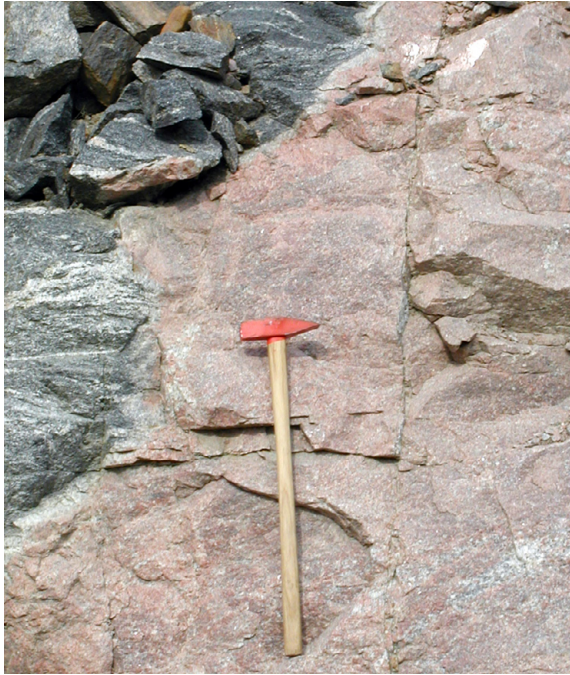
Fig. 4. Röd, fint medelkornig, leukokratisk granit som intruderar svart, gnejsig, ådrad glimmerrik tonalit (JNR045006, 6446610/1314945). Den leukokratiska graniten som bildar större massiv söder om Alingsås är ofta alltför spröd (>30 % i LA-värde) för att duga som klass-2 material. På den här lokalen är dock graniten tillräckligt bra ( K_k = 10,3\% , LA = 28,9 %) för att duga som klass 2-material tack vare en finare kornstorlek än normalt. Foto Jonny Sangskar.
