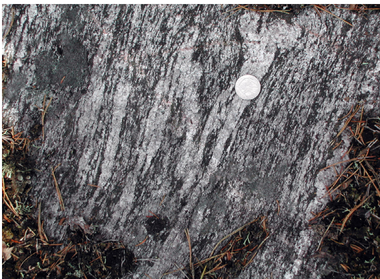
Fig. 6. Tonalit, gnejsig, ådrad, grovt medelkornig (DLL050175, 6455330/1310640) vid Knutstorp, 2 km norr om Stora Mellby. En migmatisk tonalit i närheten (MGO055084A, 6456200/1309950) ger dåliga tekniska resultat ( K_k = 28,2\% ). Foto Lena Lundqvist.
