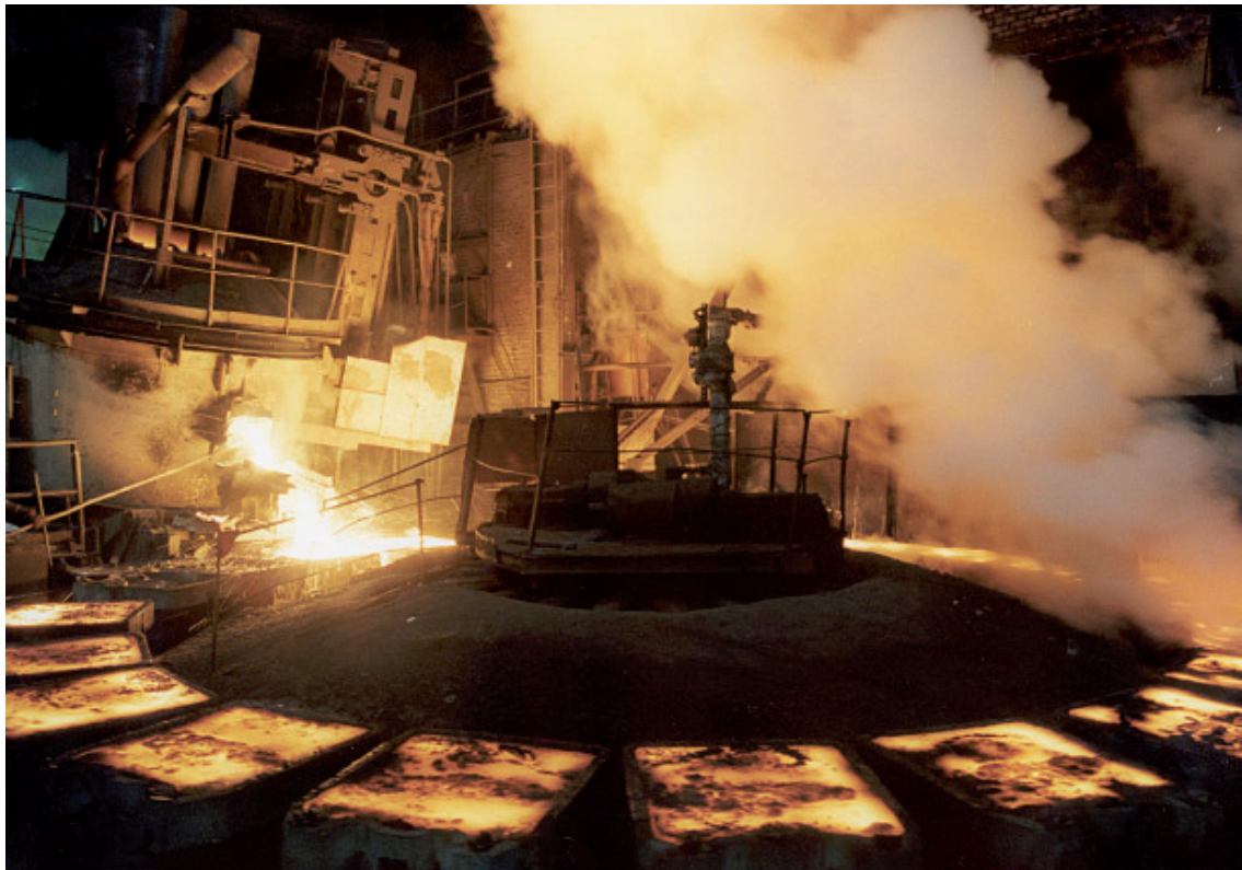
Gjutning av nickelanoder i Norilsk. Foto: MMC Norilsk Nickel.
