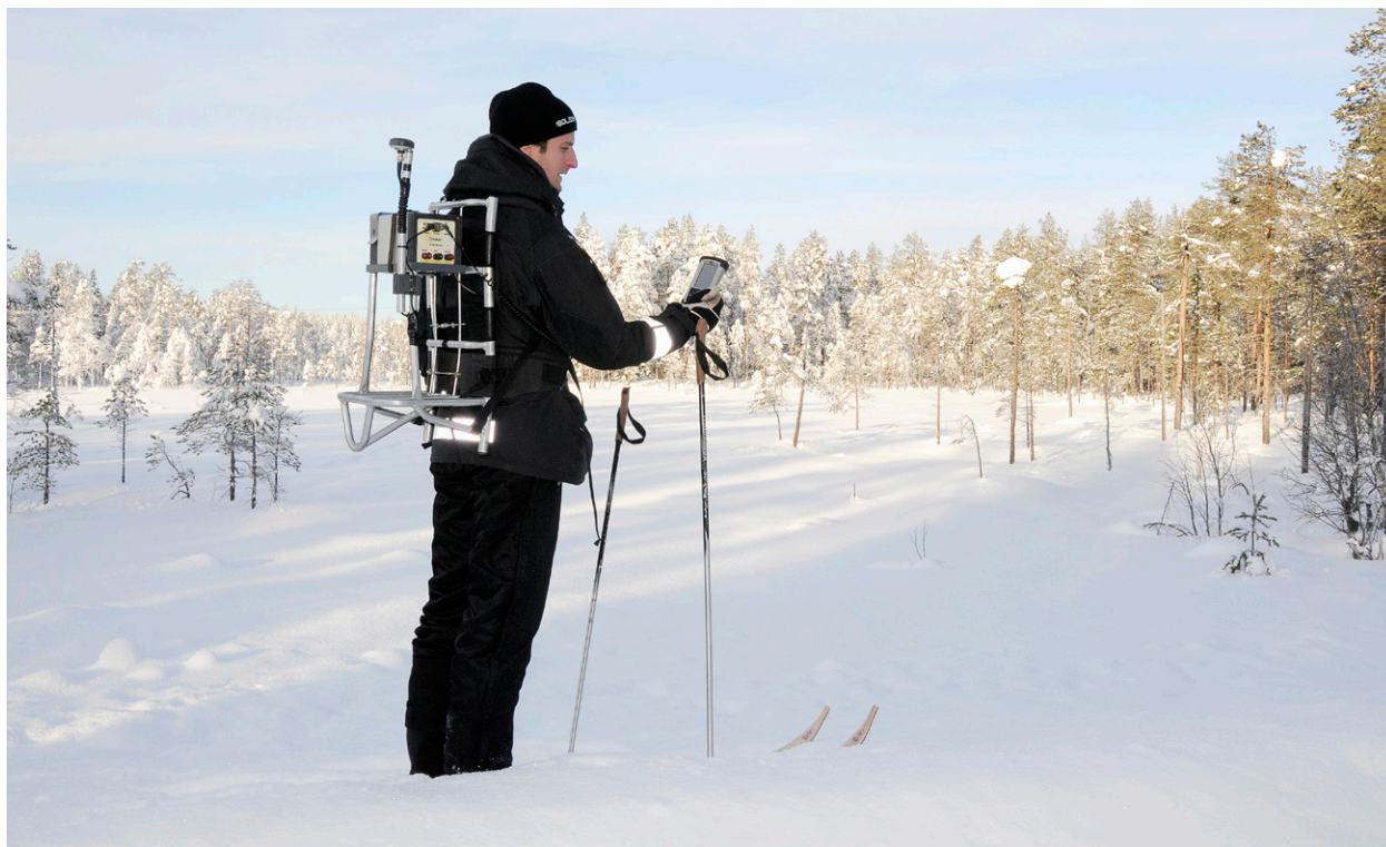
Fälttekniker Kristofer Lundqvist på Bolidens prospekteringsavdelning mäter i skogarna runt Boliden med EM3-2001-tekniken. Elektriskt ledande kroppar lokaliseras, till exempel sulfidmalmer. Foto: Boliden AB.
