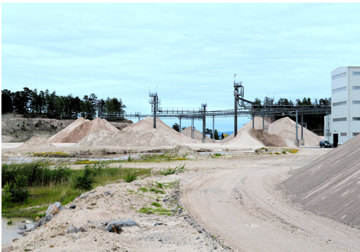
Baskarp som producerar specialsand för gjuterier och glasfibertillverkning. Specialsand definieras som industrimineral. Foto: Peter Åkerhammar, SGU
