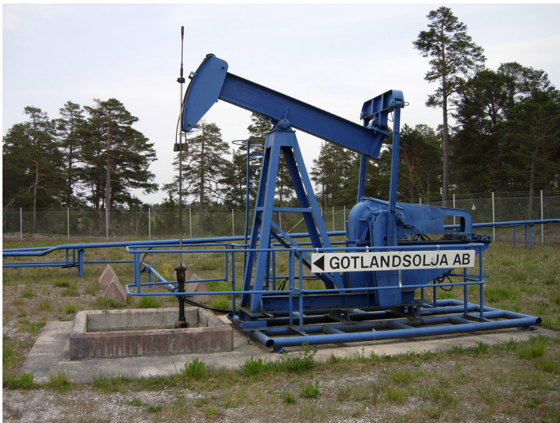
Figur 2. Exempel på oljepump och brunnskammare vid Risugns på Gotland. Foto: Linda Wickström SGU.
