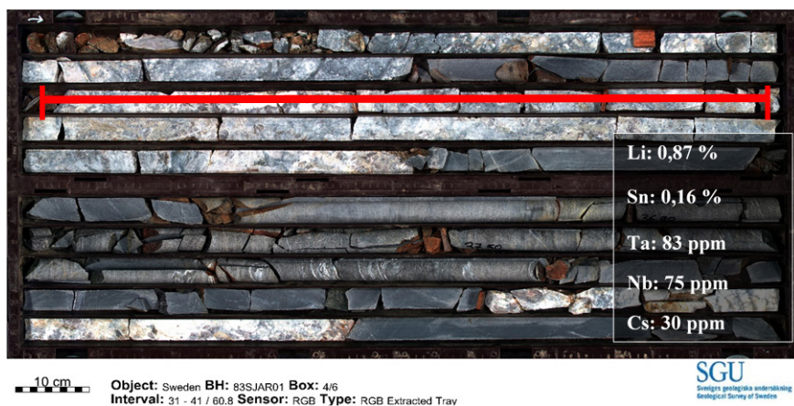
Figur 13. En borrkärnelåda innehållande LCT pegmatit från Järkvissle. Röd markering visar sektioner som valts ut för kemisk analys. Analysresultat för utvalda element visas. Foto: Specim.
