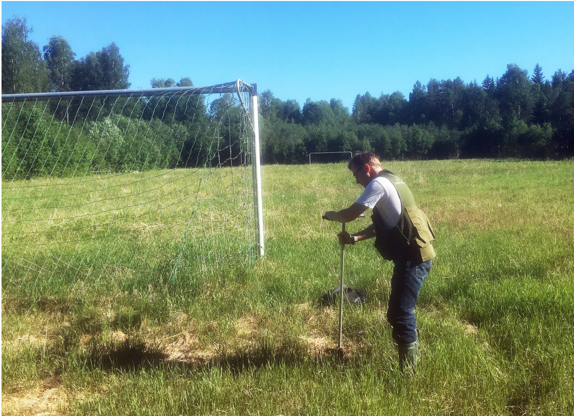
Figur 22. Provtagning med jordborr på sandmagasin i Bredsjö. Foto: Anders Hallberg.
