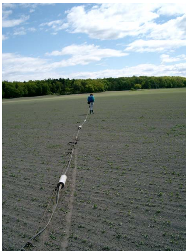
Figur 4. Mätning med OhmMapper på lokalen Fiholm mellan Eskilstuna och Strängnäs.
