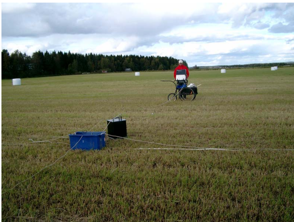
Figur 3. Mätning med RMT (radiomagnetotellurik) vid Stöcksjö nära Umeå. Metoden utnyttjar radiosändare i frekvensområdet 15-250 kHz.
