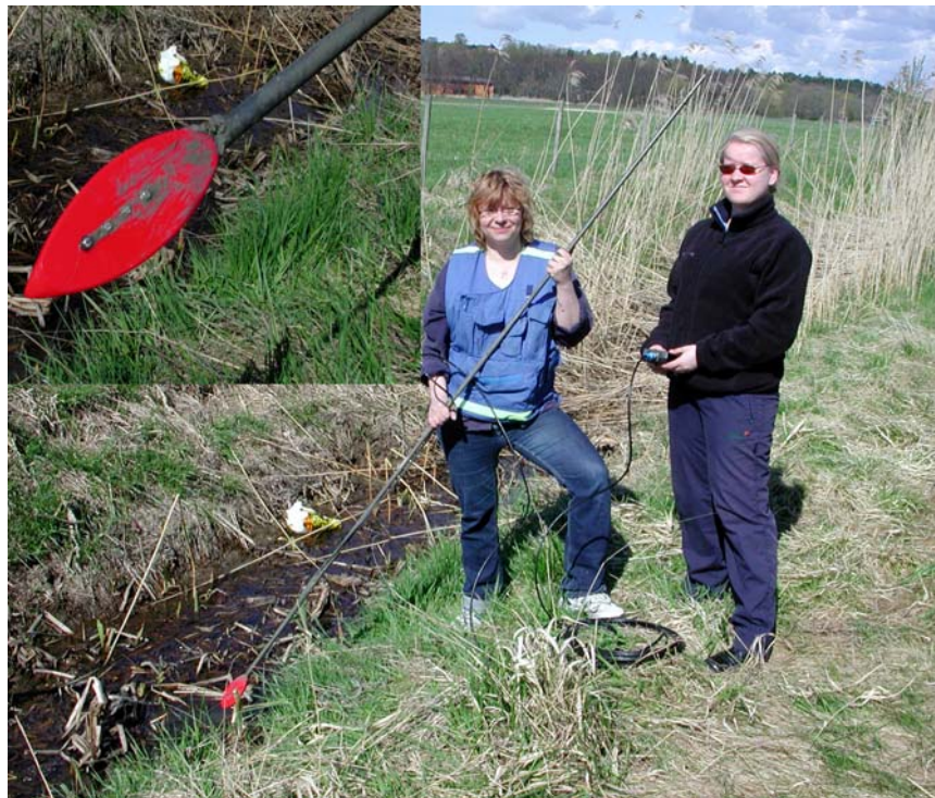
Figur 5. Lena Persson (SGU) och Taija Houtari (GTK) med resistivitetssonden på Kungsängen några kilometer söder om Uppsala
