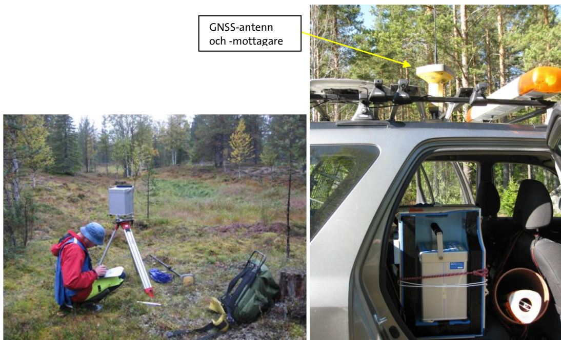
Fig. 1A. Tyngdkraftsmätning med Scintrex CG-5 gravimeter i obanad terräng i Nattavaaraområdet, Lappland. Fig. 1B. Den rörliga GNSS-mottagaren, rovern, har vid SGU:s tyngdkraftsmätningar antennen fastmonterad på biltaket. Utrustningen styrs via en handdator inne i bilen.
