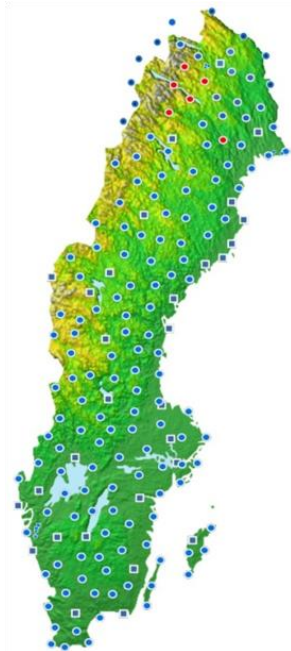
Fig. 2. Det så kallade SWEPOS-nätet består av ett stort antal fasta GNSS-stationer (Global Navigation Satellite System). På kartan är dessa markerade som blåa punkter. Kartan publiceras med tillstånd från Lantmäteriet (2011-09-29).
