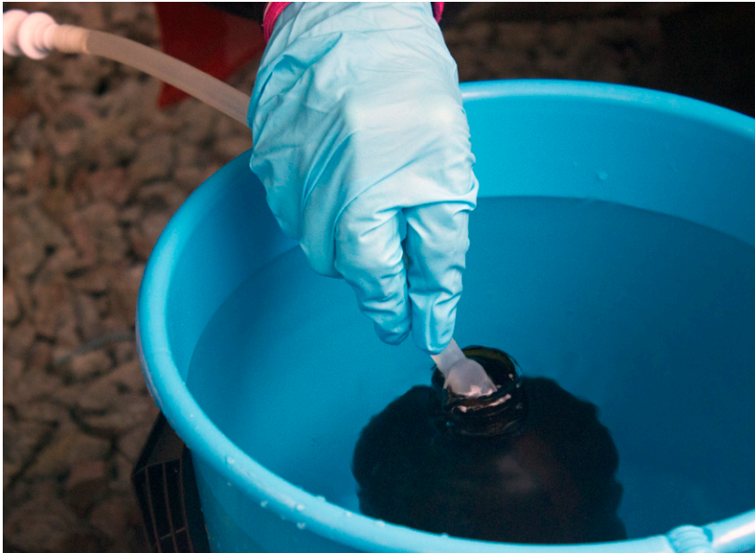
Figur 5. Provtagning under vatten enligt bottle/ bottle-in-can-metoden. Foto: Maria Åkesson.
