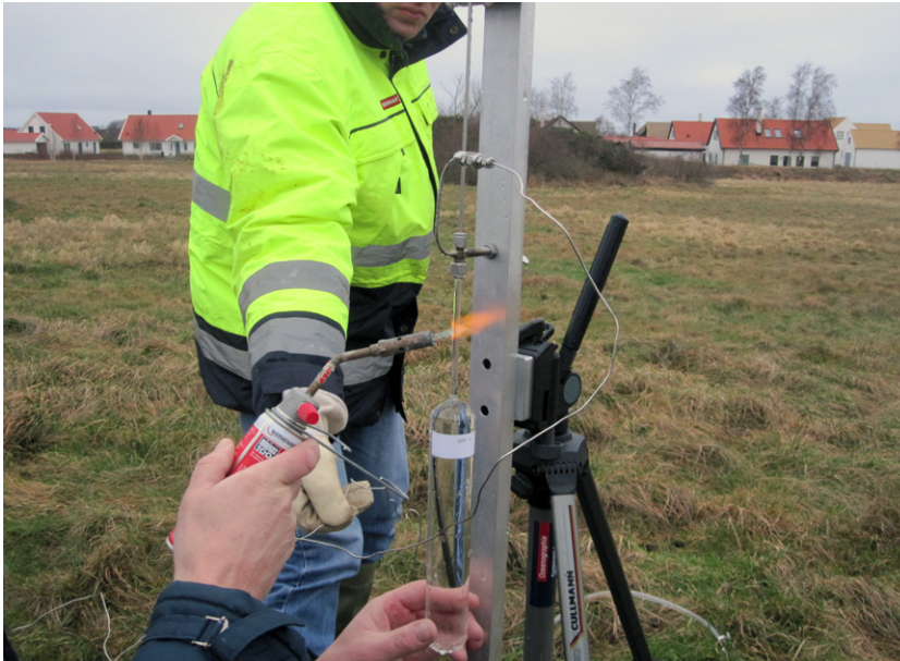
Figur 6. Provtagning enligt headspace-metoden. Här håller provtagningskärlet precis på att förseglas. Foto: Charlotte J. Sparrenbom.
