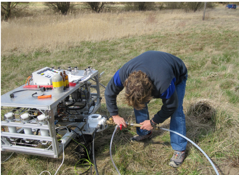
Figur 7. Provtagning av krypton-85 och argon-39 genom avgasning av det uppumpade vattnet. I bilden syns R. Purtschert från Universitat Bern, som utvecklat provtagningsmetodikerna och instrumentet. Foto: Charlotte J. Sparrenbom.
