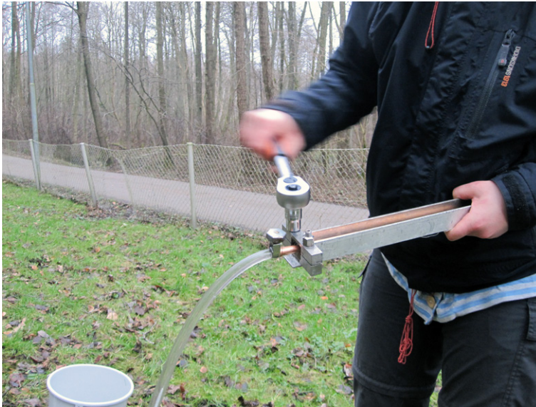
Figur 3. Helium-3-provtagning enligt kopparrörsmetoden. Här håller kopparröret just på att förslutas. Foto: Charlotte J. Sparrenbom.
