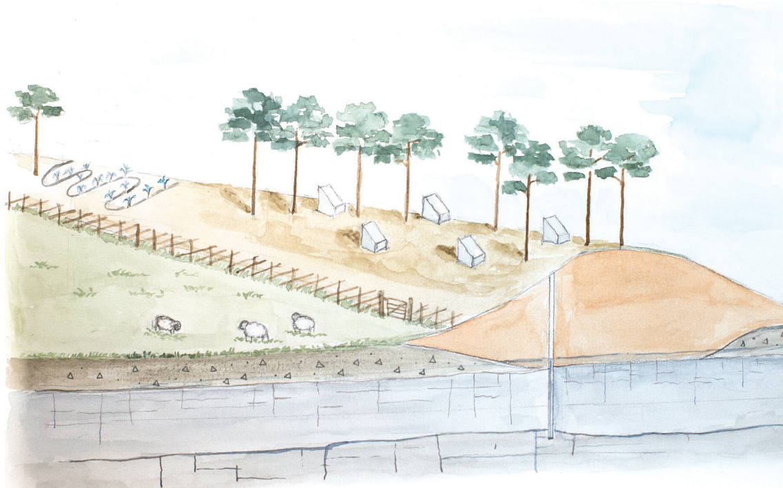
Figur 8. De fem brunnarna (ett brunnsgalleri) i grundvattnets flödesriktning utnyttjar både grundvattenmagasinet i jord och berg. Genom att använda sig av flera brunnar får man en större kapacitet, möjlighet att styra uttagen samt en större möjlighet att tillgodogöra sig en stor del av det infiltrerade grundvattnet.
