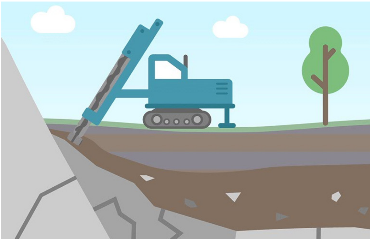
Figur 5. Bild över en hammarborrning i olika lager av jord och berg. Bilden är tagen från en animation från Geopraktisk. Illustration: Bloody Honey.
