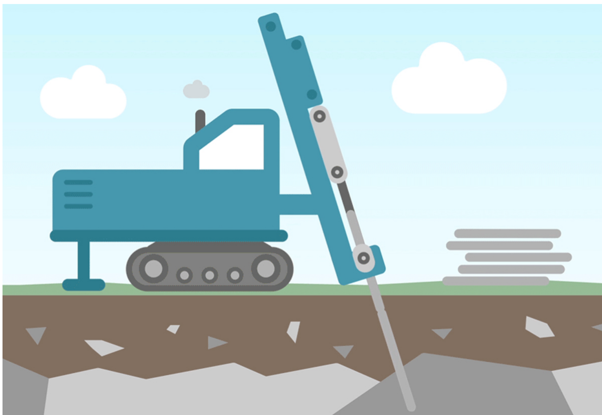
Figur 4. Bilden visar förenklat hur en kärnborrningsrigg fungerar. Bilden är tagen från en animation från Geopraktisk. Illustration: Bloody Honey.
