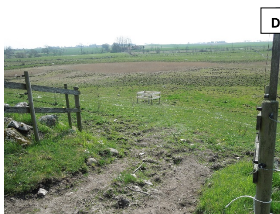
Figur 23 a–d. a) PVC-rör i enmeterslängder. b) Spadborr med jordkax som visar övergången mellan torv och underlagande sand. c) Tvättad sand packas utmed rörets sidor för att det ska bli stadigt. d) Ett inhägnat grundvattenrör. Foto: 23 a–c Magdalena Thorsbrink, 23 d Jan-Åke Nilsson.
