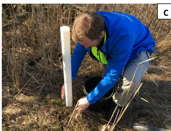
Figur 23 a–d. a) PVC-rör i enmeterslängder. b) Spadborr med jordkax som visar övergången mellan torv och underlagande sand. c) Tvättad sand packas utmed rörets sidor för att det ska bli stadigt. d) Ett inhägnat grundvattenrör. Foto: 23 a–c Magdalena Thorsbrink, 23 d Jan-Åke Nilsson.
