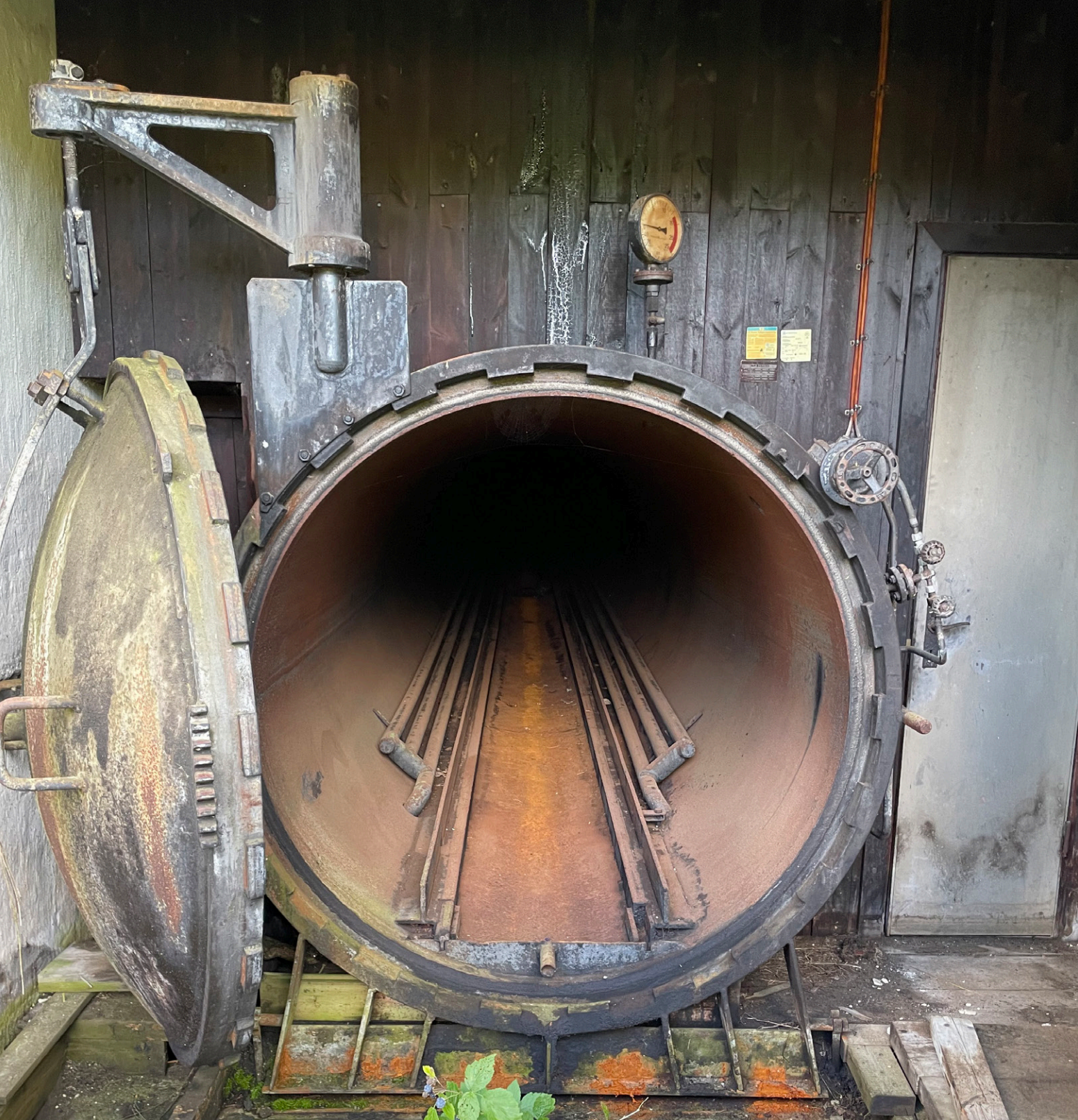
Impregneringstubb på Södervägs f.d. brädgård söder om Visby. I tuben har tryckimpregnering med kreosot utförts. SGU undersöker området med avseende på kreosotförorenad jord och grundvatten inför senare eventuella åtgärder. Foto: Elin Edberg.
