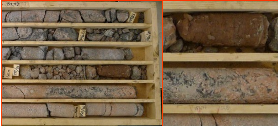
Figur 19. Borrkärna från kärnborrning genom Söderströmsförkastningen vid Slussen. Kärnförlust på ca 2,5 m fördelad på två upptag antas bero på svällande lera. En mindre mängd av sådan lera fanns i den bruna biten av omvandlat berg, och uppvisade ett svälltryck på 150 kPa (Clarín & Clark 2015). Den bortspolade leran kan antas kunna svälla med minst lika högt tryck).
