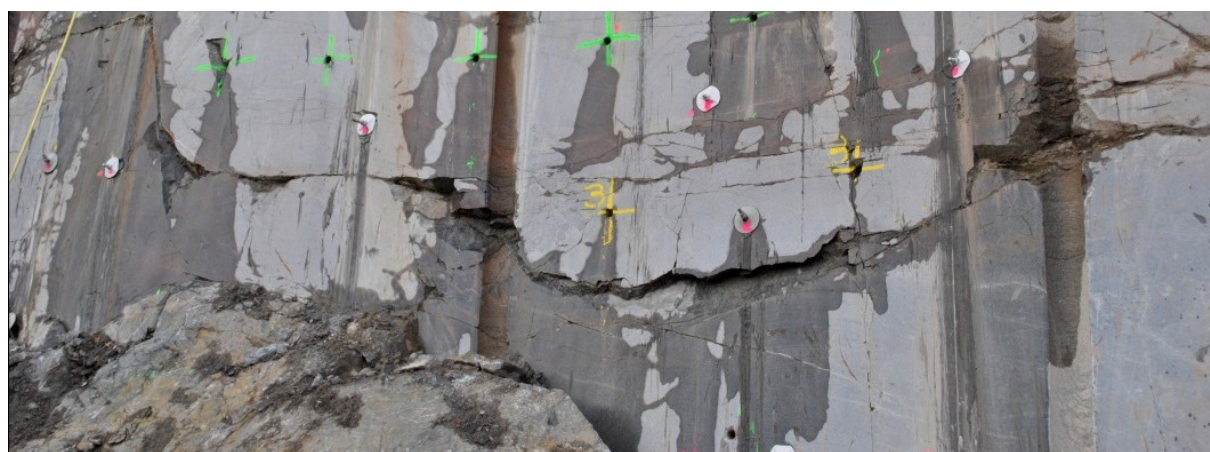
Figur 2. Ulvsunda. Sedimentgnejs med oregelbundna bankningssprickor ca 10 m under bergytan, fyllda med några cm finmaterial. Foto: Lars Bergkvist, Golder.
