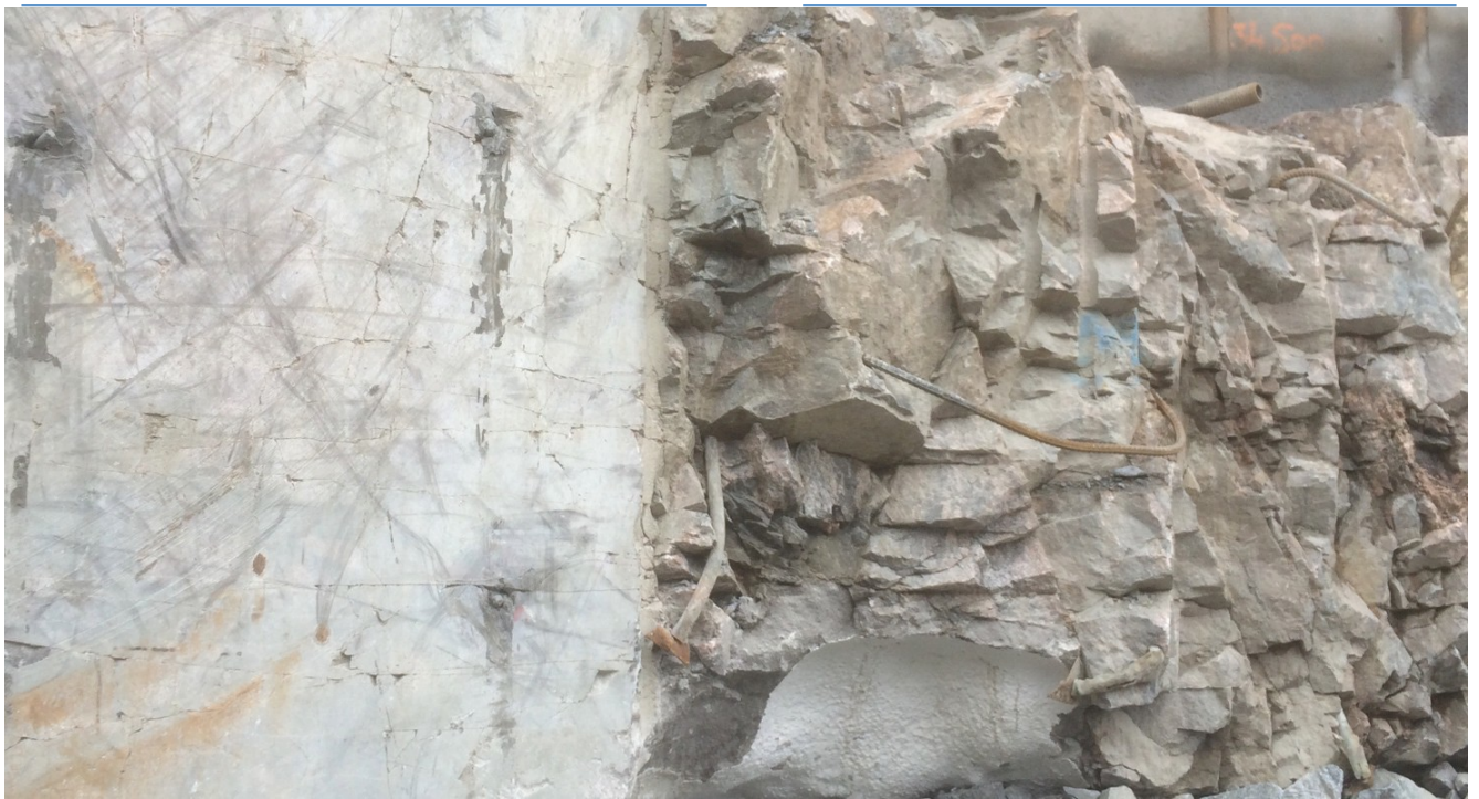
Figur 17. Jämförelse mellan sågad och sprängd bergmassa där även den sågade ytan behöver förstärkas. En sågad yta kan vara förrädisk och uppmärksamhet krävs då sprickorna inte framträder lika tydligt. Foto: Jörgen Theander, Golder.
