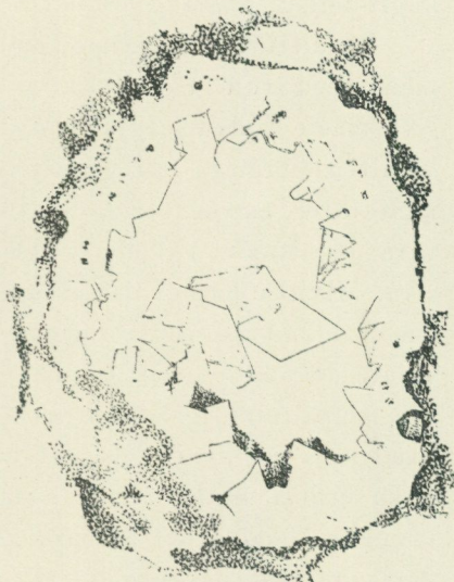
Fig. 70. Ett delvis omvandlat kvartskorn ur sandstenen vid Dagstorpssjön. \times 200 . Från den fullständigt omvandlade randzonen skjuta spetsiga mikroklinkrystaller in i den ännu kvarvarande kvartssubstansen, hvilken genom några större sådana nästan afdelas i tvenne delar.
