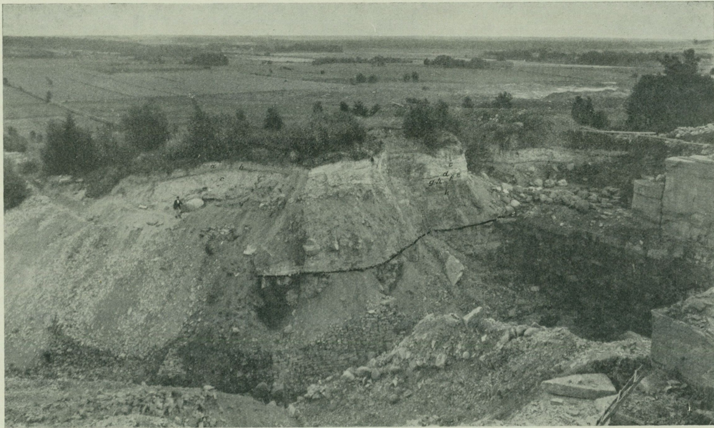
Fig. 1. Från stenbrottet S om Skultorps station mot Ö. I förgrunden till höger lodräta partier av ortocerkalk, därunder alunskiffer, som fortsätter åt vänster under den svarta linjen. Över denna den kvartära lagerserien, k--a. I bakgrunden slätten, som vid synranden begränsas av Hökensås. O Fr. Andersson fot.
