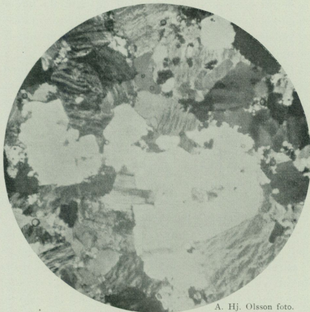
Fig. 13. Röd granit. 1,800 m V om Finnhöjden, Brattfors socken. Mikrofoto med korsade nikoler. \times 12 .
