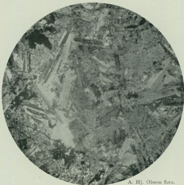
Fig. 8. Hyperitdiorit, 850 m Ö om Glumserudstorp, Väse socken. Mikrofoto med korsade nikoler. \times 12 .
