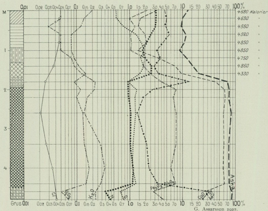
Fig. 32. Kemiskt diagram från Lina myr. Högre askhalt gör jordarten mindre god till brännrotv, högre halt av kväve (N) och fosfor ( P_2O_5 ) gör den lämpligare till odlingsjord. Klorokurvans (Cl) överraskande låga värden i den marina gyttjan beror på klor salternas utlösning och cirkulation inom lagerföljden.
