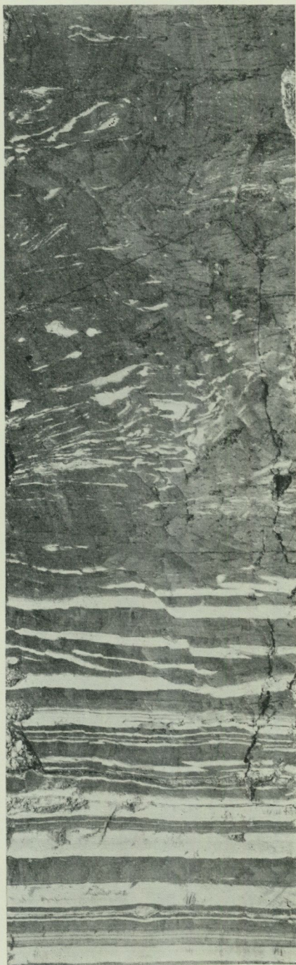
Fig. 28. Provpelare av varvig lera under 13 m isälvsgrus vid Åbyfors. Pelaren, som är 75 cm hög, insamlades av O. Claesson 1930 vid punkt 36.8 å fig. 20. Bildens övre kant är kontakten mellan isälvsgrus och lera. I lerans övre del är varvheten fullständigt förstörd, längst ned till synes ostörd. Under bildens nedre kant följer ytterligare 56 cm varvig lera och därunder sand. Djupare grävning omöjliggjordes av tillrinnande vatten.
