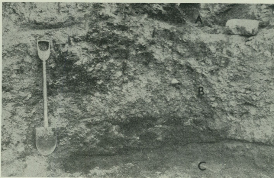
Fig. 22. Skärning i södra väggen av grustag S om Finnböle i Hedesunda socken. A = svallgrus. B = morän. C = isälvsgrus. Fig. 23 visar skärningens fortsättning åt väster.
