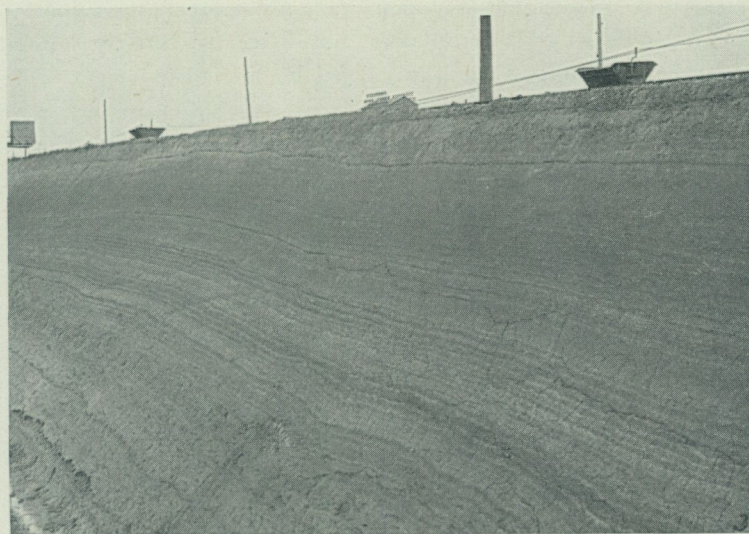
Fig. 33. Västra väggen i lergraven vid Genevads tegelbruk. Överst finns regressionssand och -mo, därunder 5—7 m varvig lera med neråt allt tjockare varv. Nederst t.v. flyter de vattenfyllda, sandigt moiga varven ut ur skärningens sida. — Foto H. Tullström 1950.
