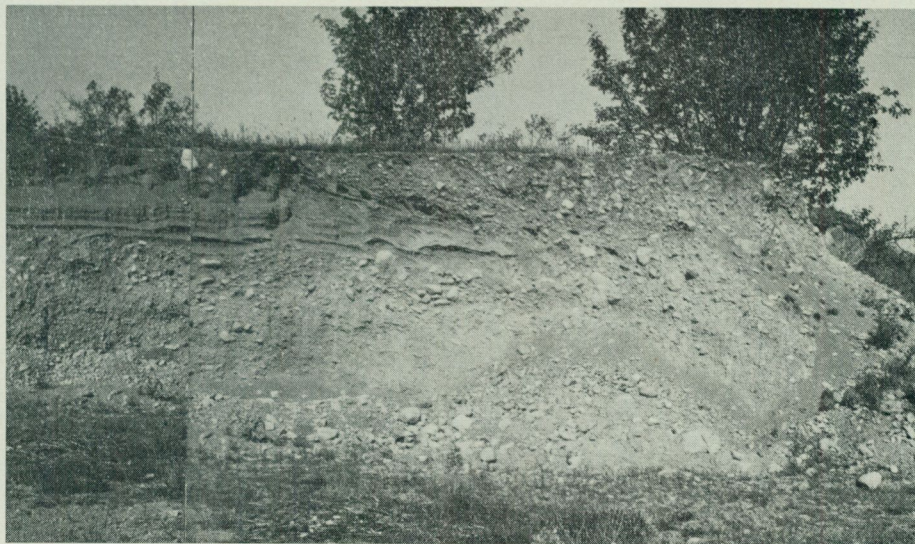
Fig. 26. Grustag NO vid Slädene kapell (E 8/9). Det grova gruset till vänster på bilden täckes av 1 à 1.5 m sand. I bildens högra del överlagras grovt grus, uppskjutet från NO (=höger), de tidigare avsättningarna taktegeförmigt. — Foto E. Olausson 1951.
