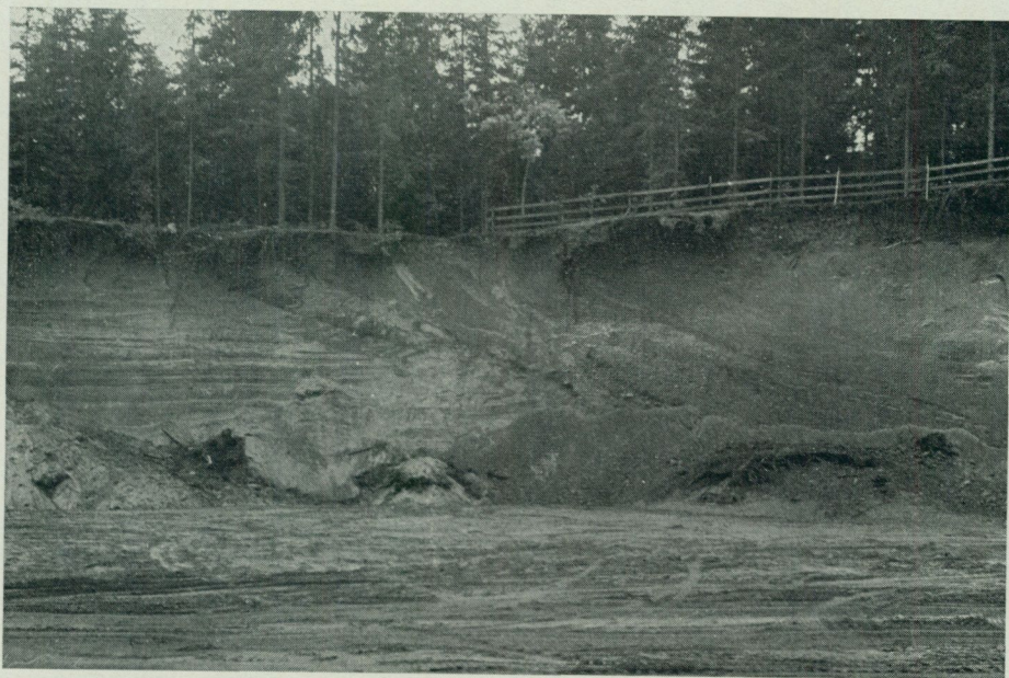
Fig. 27. Grustag i Leveneplatån (G 9), 0,7 km NO om kyrkan. Längst till vänster i norra vägen ligger vackert skiktad grusig sand i ostörd lagring. Överskjutningsplan och veckningar av lagren tyder på ett tryck från höger (=NO). I bildens högra hälft en hårt packad moig mellansand, vari vid ett tillfälle iaktogs sönderbrutna stycken av styv glacial lera med bevarad varvighet. Överst, under staketet, svallgrus. — Foto E. Mohrén 1968.
