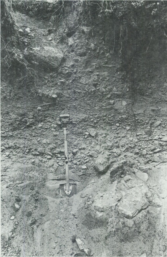
Fig. 16. Grus- och sandskikt i sandig-moig morän i samma skärning som i fig. 15. Avståndet mellan fotograferingsplatserna är ca 10 m. Foto förf. 1986.
