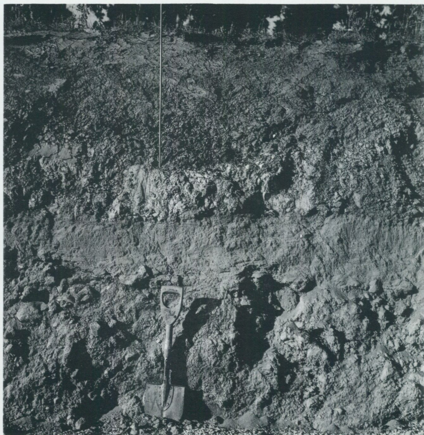
Fig. 20. Skärning 400 m SO om Nyåker (8a). Överst postglacial lera (vid sticksonden), därunder glacial lera (ljus lager) underlagrad av sand som vilar på sandig-moig morän (vid spaden). Foto förf. 1984.
