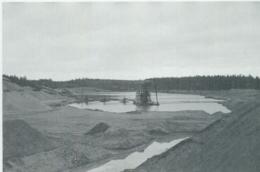
Fig. 4. I Hallsta grustag, 1,2 km nordöst om Hallsta (5i), bryts grovt åskärnmaterial till ett djup av 22–25 m under grundvattenytan. Foto förf. 1990.
