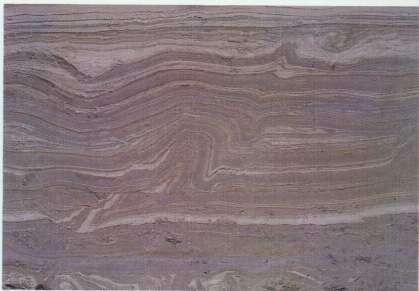
Fig. 12. Detalj av skiktad finmo och mjäla på 3,7 m djup i skärningen som redovisas i fig. 11. Sedimenten har utsatts för istryck från ca norr (till vänster i bilden). Notera sidförskjutningen längs lerskiktet i den övre delen av bilden. Foto förf. 1991.
