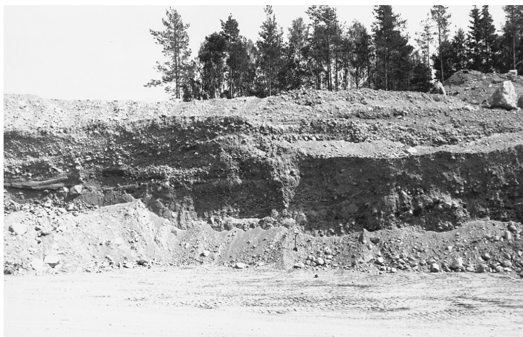
Fig. 28. Skärning i östra åssidans i grustaget 400 m söder om Sonstorp (3 h). Åsmaterialet är heterogent sammansatt med partier av strukturlösa sediment, moränartade sediment, lager av grus, stenigt grus och sand. Foto mot norr, förf. 1990.
