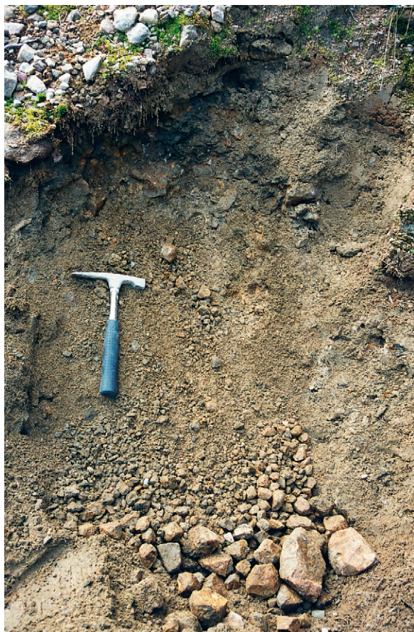
Fig 19. Närbild av sandig morän vid Jordås (1 a). Moränen utgörs av en relativt finkornig hårt packad bottenmorän. Moränen innehåller en mycket liten andel av grus, sten och block (20 %). En analys av den totala kornstorleksammansättningen från denna lokal redovisas som jordprov 6 i figur 21. Foto förf. 1999.
