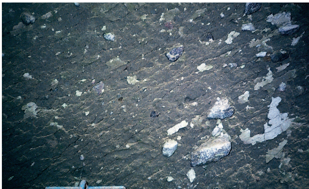
Fig 19. Närbild av sandig morän vid Jordås (1 a). Moränen utgörs av en relativt finkornig hårt packad bottenmorän. Moränen innehåller en mycket liten andel av grus, sten och block (20 %). En analys av den totala kornstorleksammansättningen från denna lokal redovisas som jordprov 6 i figur 21. Foto förf. 1999.
