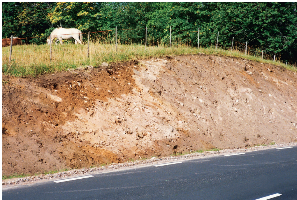
Fig. 17. Skärning i krönet på en liten drumlin 500 m sydost om Sandhults kyrka (1 e). Jordlagren består där huvudsakligen av morän. Det ljusa lagret på bilden utgörs emellertid av välsorterat sandigt grus. Foto förf. 1993.
