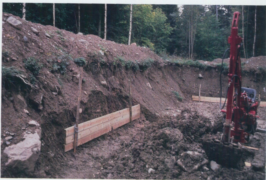
Fig. 19. Skärning i moränlera 300 m väster om Alören (3f) på Granö, södra Oxhalsö. Moränleran, som håller 16% ler, är starkt kalkhaltig och har lågt blockinnehåll och måttligt till lågt steninnehåll. Färgen är, som framgår av bilden, rödbrun. I moränleran finns decimetertjocka sandskikt. Från 1,5–2 m under markytan är moränleran block- och stenfattig och håller 27% ler. Foto förf. 1992.
