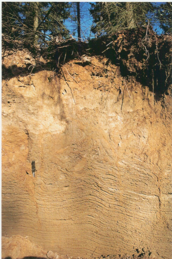
Fig. 24. Strukturlös finsandig grovsilt (prov 26469) underlagrad av silt med tunna lerskikt (prov 26463). Silten underlagras av isälvsgrus. Liten husbehovstäck 1,8 km ONO om Gryts kyrka (6i). Foto förf. 1994.
