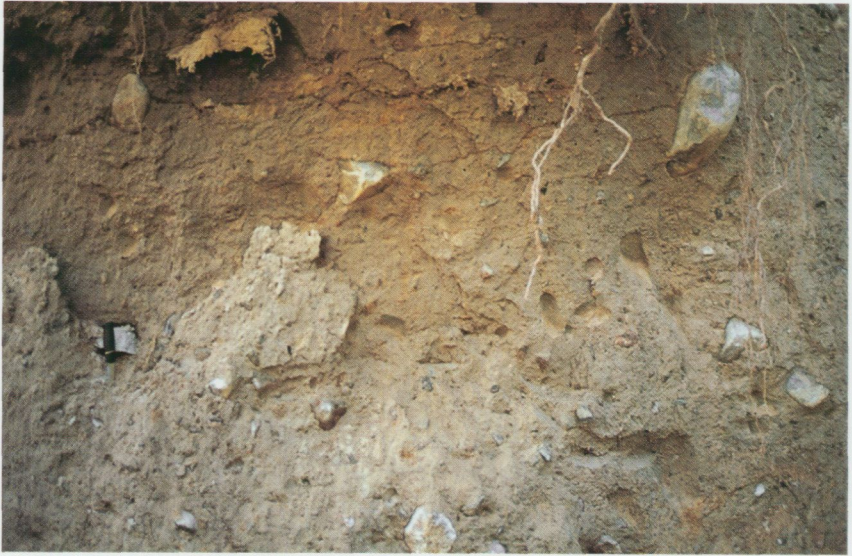
Fig. 15. Sandig morän med låg till måttlig stenhalt och låg blockhalt, se även prov 26466 i kornstorlekstabellen. Ca 1 km norr om punkt 102,44 (9j). Foto förf. 1994.
