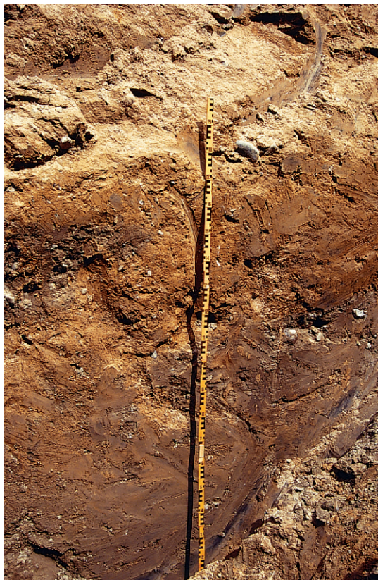
Fig. 17. Skärning i drumlin vid lokal Hemmingstorp V, 6520635/1389650 (4 h). Överst en ca 3,9 m mäktig brun sandig morän som överlagrar en mörkgrå sandig-siltig morän som i skärningen är ca 1,1 m. Foto förf. 1996.
